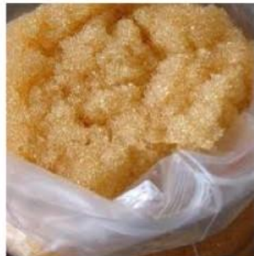
图 3-4 强酸性阳离子交换树脂结构
